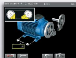
Figura 1. El programa le guía durante el procedimiento de montaje de las unidades en las poleas.
